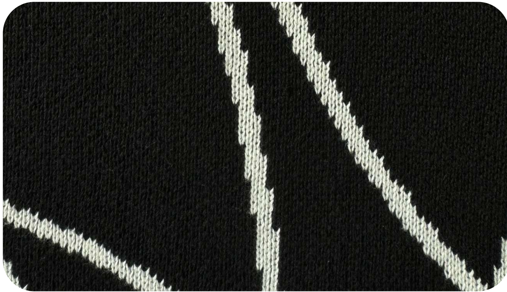
Fig: Jacquard interlock frontside
